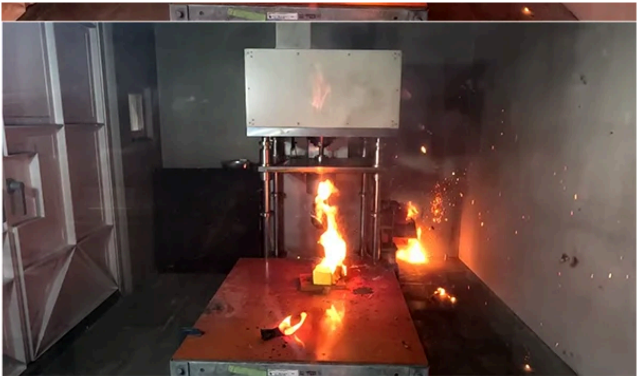
リチウムイオン電池の類焼実験によりセルが吹き飛んで燃焼する様子
