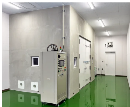
安全性試験を実施するRC部屋（鉄筋コンクリート部屋、幅4m x 奥行3m x 高さ3.5m）
