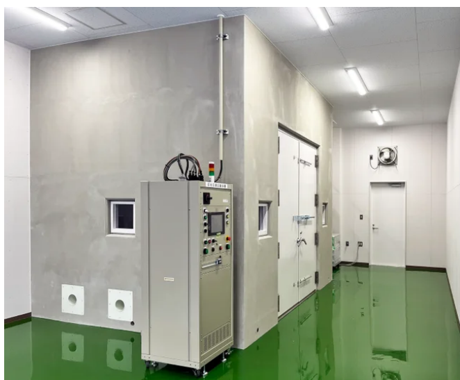
安全性試験を実施するRC部屋（鉄筋コンクリート部屋）
