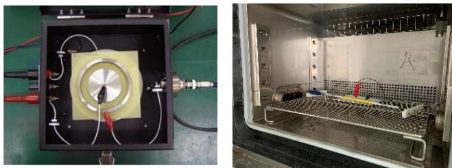
サンプルの表面上、または回路基板のパターンに規定の電圧を印加し、通常1分後の抵抗値を測定します。超高抵抗値を測定するため、電磁遮蔽ボックス内で実施します。高温高湿状態、水中、油中での測定も対応致します。また、液体状態、薄膜状態、ゴム状のサンプル、絶縁スリーブやチューブの特殊形状サンプルの測定もご相談下さい。(JIS C5012、JIS C5016、JIS C6471、JIS C6481、IPC-TM-650)
