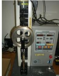
プリント配線板のパターン銅箔の密着性を機械的に評価します。90°および180°方向引き剥がしの2方法があります。ご要望に合わせ、自由回転ドラムやスライディングプレートなどの特殊な治具も取り揃えております。
