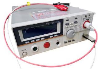
規定の速度でサンプルに試験電圧を昇圧印加し、表面放電、空中放電、絶縁破壊の発生の有無を評価します。10 kVまでの電圧印加における評価が可能です。各種形状の電極を取り揃えており、柱状電極・球状電極を用いた表面耐電圧試験、テーパーピン電極を用いた沿層耐電圧試験、油中試験も対応可能です。交流電圧やインパルス耐電圧試験にも対応しております。(JIS C5012、JIS C5016、JIS C6471、JIS C6481、IPC-TM-650)
