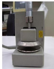
インピーダンスアナライザーを用い、プラスチック成型品やフィルムの比誘電率および誘電正接を測定します。サンプルの形態に応じ電極接觸法、電極非接觸(間隙)法が選択できます。10 MHzまでの測定が可能です。高周波測定や高温・低温環境下における測定もご相談ください。(ASTM D150、JIS C6481)
