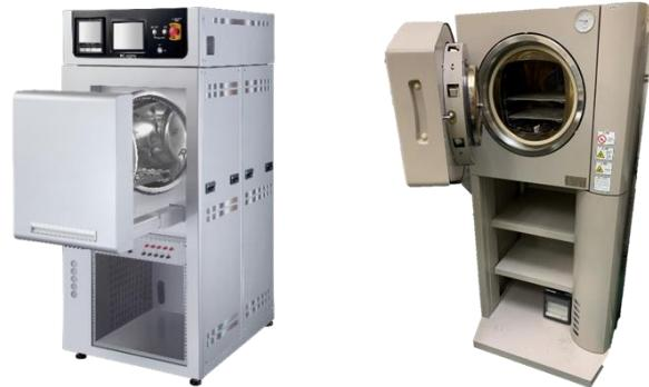
HAST(High Accelerated Stress Test)またはPCT(Pressure Cooker Test)は、IEC60068-2-66 に規定されている、小型電子機器の標準的な信頼性評価方法です。不飽和(85%RH)状態または飽和(100%RH)状態において、高温に更に気圧の負荷を加え、特性劣化を著しく加速します。弊社では、イオンマイグレーション試験と組み合わせた絶縁性評価も可能です。(IEC60068-2-66、JEITA ED-4701/100B、JPCA-ET08)
