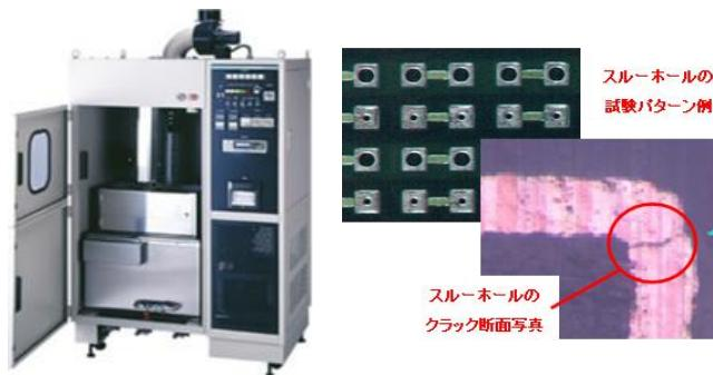
オイルを用いて、260°C ⇄ 常温等の2液相間に交互にサンプルを浸漬し、極めて短時間で熱衝撃ストレスを与える試験です。主に多層基板の銅はく密着強度や、スルーホールの導通安定性を評価するために用いられます。導通抵抗の連続測定による故障判定、故障後の解析までサポートします。
