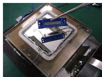
規定の温度に設定したはんだ槽にサンプルを浸漬し、サンプル耐熱性を評価する試験です。プリント配線板、フレキシブルプリント配線板、プリント配線板用銅張積層板、フレキシブルプリント配線板用銅張積層板を対象とします。はんだ濡れ性試験、はんだの銅喰われ評価などにもご活用下さい。(JIS C5012、JIS C5016、JIS C6481、JIS C6471、IPC-TM-650)
