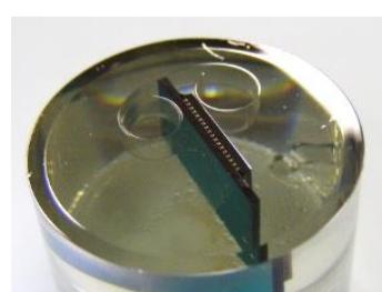
断面観察はサンプルを切断、研磨し、表面化することで、観察部位の光学顕微鏡、SEMでの微小観察やEDXでの元素分析など、より詳細な観察を可能にします。ビルトアップ基板、電子部品、車載部品、太陽電池モジュールの構造解析、寸法測定など多数の実績を積んでおります。大型のモジュールの小片切り出しも対応しております。
