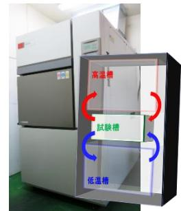
熱膨張係数が異なる材料で構成されている電気・電子部品に対し、低温と高温を交互に負荷する熱衝撃ストレスを与え、熱応力に対する耐性を評価します。
