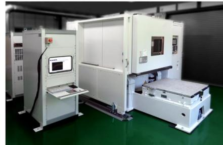
路面を高速で走行する自動車には様々な振動・衝撃が長い年月をかけて繰り返し加わります。更に、自動車は屋外の厳しい環境条件下で使用されるため、振動に環境条件を加えた複合環境振動試験が要求されます。多様な車載機器が曝される振動・衝撃に対する耐性を、実際の設置・使用環境に基づいて評価します。治具の設計・製造から承っております。
