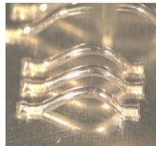
銅と太線アルミ・リボン対応のウェッジボンダーと、金細線対応のボールボンダーを保有しております。SiC を始めとしたパワー半導体チップ、TEG チップへのワイヤの実装が可能です。
