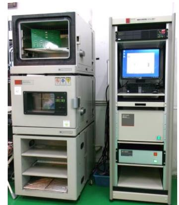
最大 3,000 V を印加可能なマイグレーションテストを用いて、パワーデバイスのモールド、絶縁材、ゲート絶縁膜、逆流防止ダイオードの逆方向等に対し、長時間のバイアス試験を行い、絶縁耐力を評価します。高い電流測定精度を持ち、絶縁抵抗値をリアルタイムでモニタすることができるため、故障に至る経時的な劣化現象を検出できます。
