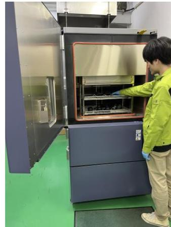
運転中に自動車曝される急激な温度変化(熱衝撃)に対する耐性を評価する試験です。試験槽内に吹き込む風をダンパーで切替えて温度制御する「ダンパー式(空気入替型)」と、試験槽が高温と低温の間で物理的に移動する「エレベータ式(試料昇降型)」を取り揃えています。
