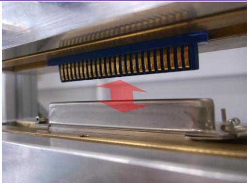
コネクタを規定の速度で数百～数万回挿抜き、繰返し動作耐性(嵌合時の異常の有無・嵌合時の性能の変化)を評価します。ケミックスでは専用の試験装置を開発し、あらゆる形状のコネクタについて、自動挿抜を可能としています。
