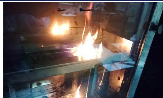
FMVSS 302 水平燃焼性試験は、乗用車、トラックおよびバスの室内に使用される内装材に発生する火災を想定した試験です。ケミックスでは ISO 3795、GB8410 等、あらゆる類似規格、各自動車メーカーの個別規格にも対応可能です。更に欧州では、10 席以上(運転席含む)及び最大重量 5t 以上の自動車の内装材に対して、UN/ECE R118 という規格に基づき燃焼性試験を要求しております。
