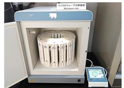
電気電子機器への有害物質 (Pb、Hg、Cd、Cr<sup>6+</sup>、PBB、PBDE、フタル酸エステル4種) の使用を禁止する RoHS 指令対応分析を行っています。最新鋭の分析装置を導入し、多数サンプルの受け入れ体制を整えています。
