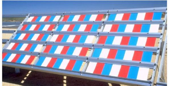
自動車のランプに使用されるプラスチック材等の自然環境への耐性を評価する試験です。米国の AMECA 認定試験機関との提携により、AMECA 登録規格に基づく屋外耐候性試験と評価レポートの発行、登録手続まで一貫して対応致します。促進曝露試験、試験サンプルの作製、技術コンサルティングも行っています。
