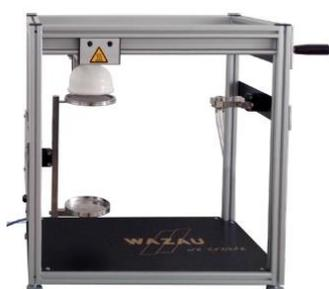
UN/ECE R118 で要求される、自動車内の天井周辺の材料の溶融性能を評価する試験です。他の箇所での火災からの、間接的な加熱により材料が溶融、滴下して乗客への被害を引き起こさないかを評価します。加熱強度 3 W/cm<sup>2</sup> の輻射パネル直下の 70×70mm サンプルが、10 分以内に溶融滴下を生じないことを確認します。
