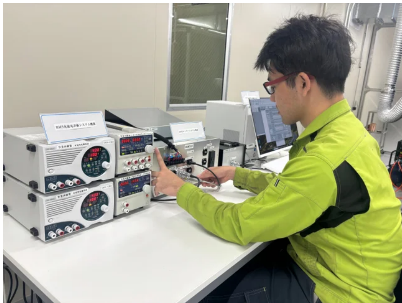
ケミトックスが開発した全固体電池用BMS評価システム
