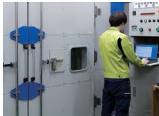
外部短絡試験装置と安全試験槽
