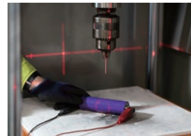
釘刺し試験のサンプル設置
