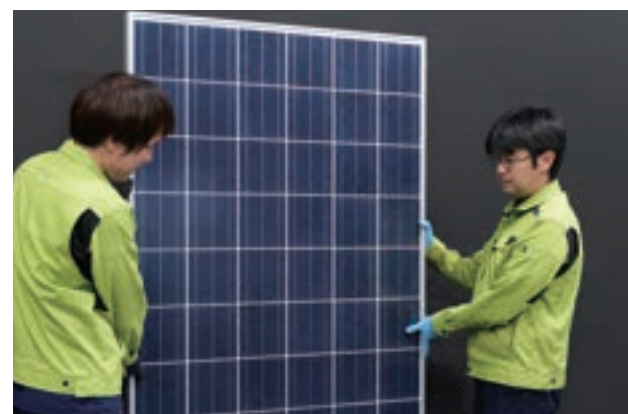
太陽電池モジュールを試験台に設置
