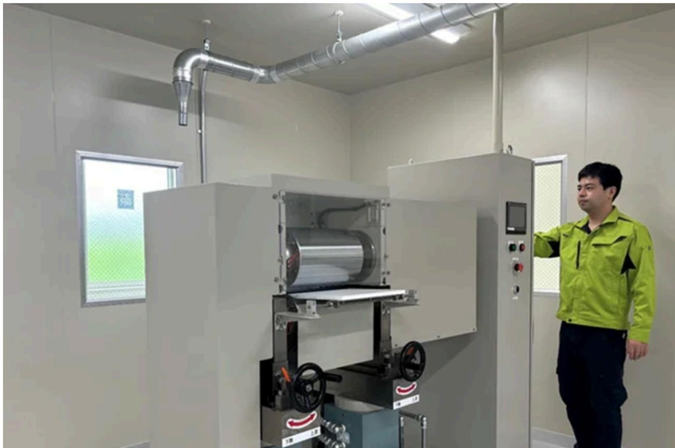
全固体電池の加圧成型に使用する20トンロールプレス機
