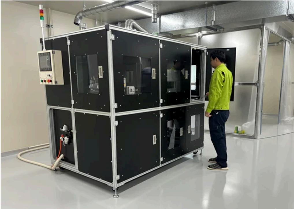
全固体電池の電極スラリーを製膜するためのコーター
