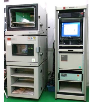
最大 3,000 V を印加可能なマイグレーションテストを用いて、パワーデバイスのモールド、絶縁材、ゲート絶縁膜、逆流防止ダイオードの逆方向等に対し、長時間のバイアス試験を行い、絶縁耐力を評価します。高い電流測定精度を持ち、絶縁抵抗値をリアルタイムでモニタすることができるため、故障に至る経時的な劣化現象を検出できます。
