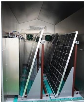
屋外で使用される自動車用製品・材料は、沿岸部のような腐食性が高い環境で使用し続けるため、金属部品、保護コーティング、プラスチック等の非金属材料の耐腐食性の評価が要求されます。ケミックスでは、国内最大級の大型塩水噴霧機を保有し、車載外装部品、電子機器等の製品をそのまま試験することができます。
