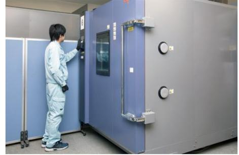
走行中の自動車での使用および保管・輸送中の車載コンポーネントを想定した多湿、高温、低温の負荷を再現します。幅 1500×高さ 2000×奥行 2000mm の内寸の大型試験槽を備えており、大型サンプルにも対応可能です。他、様々な機種 of 恒温恒湿槽、オープンを取り揃え、温湿度サイクル、結露試験にも対応しています。
