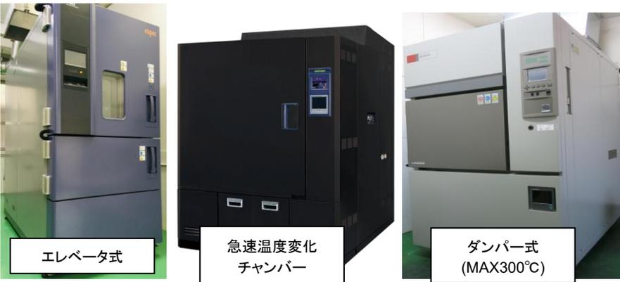
サンプルを短時間で高温と低温に交互にさらし、温度差による負荷を与えることにより、温度変化に対する耐久性を評価します。「エレベータ式」の試験機は十数秒という非常に速い温度移行にも対応することが可能です。「ダンパー式」は最高温度 300°Cまで対応可能で、次世代 SiC パワーデバイスの耐熱要求の指標として将来的に要求される最大 300°Cの評価が可能です。また、自動車用パワーデバイスの代表的な試験規格である AQG-324 で要求される熱衝撃試験は、従来の「エレベータ式」や「ダンパー式」の試験機では対応が難しく、「急速温度変化チャンバー」による評価が必要となっております。ケミックスではいずれの専用機も取り揃えています。
