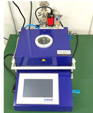
窒素+ギ酸雰囲気下で最大 400°Cまで加熱可能なリフロー装置です。接合材(銀焼結材・はんだペースト)を塗布した基板にチップを実装後、リフローすることができます。
