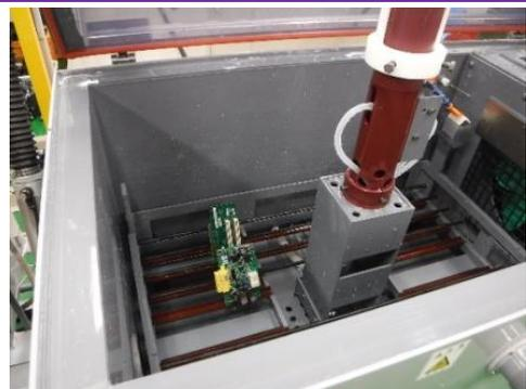
ガス腐食試験他、耐振動、耐衝撃、耐湿、耐寒、耐熱、熱衝撃、塩水噴霧等、各種環境試験を行い、その前後で接触抵抗をはじめとする測定を行い、負荷環境の経験による測定値の変化の有無を評価します。
