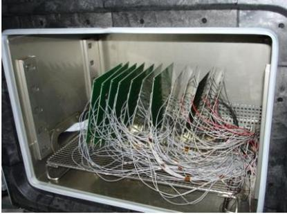
電気自動車では電装品の搭載が増えることにより、必然的に各部絶縁材料の絶縁性能が重視されます。また、自動車用パワーデバイスを搭載するプリント配線板には、並外れた絶縁耐力が要求されます。最高電圧3,000Vのマイグレーションテストを用い、絶縁材料の長期的な絶縁性能の評価を精度よく行えます。
