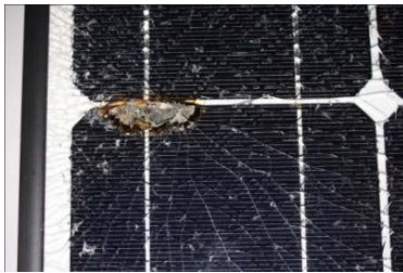
インターコネクタの接続不良による燃焼痕
