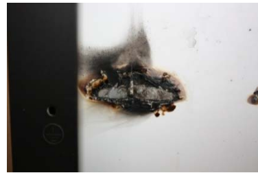
インターコネクタの接続不良による燃焼痕
