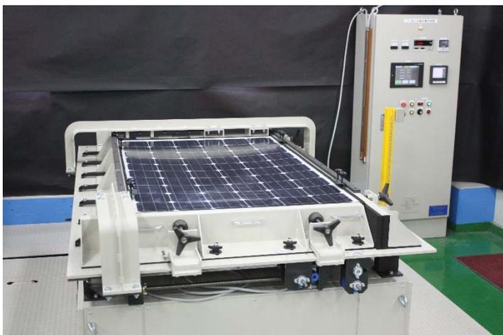
ケミトックスの気圧式機械荷重試験写真
