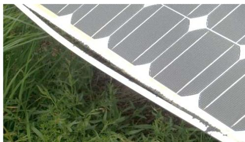
2014年2月山梨の大雪により変形したフレーム
