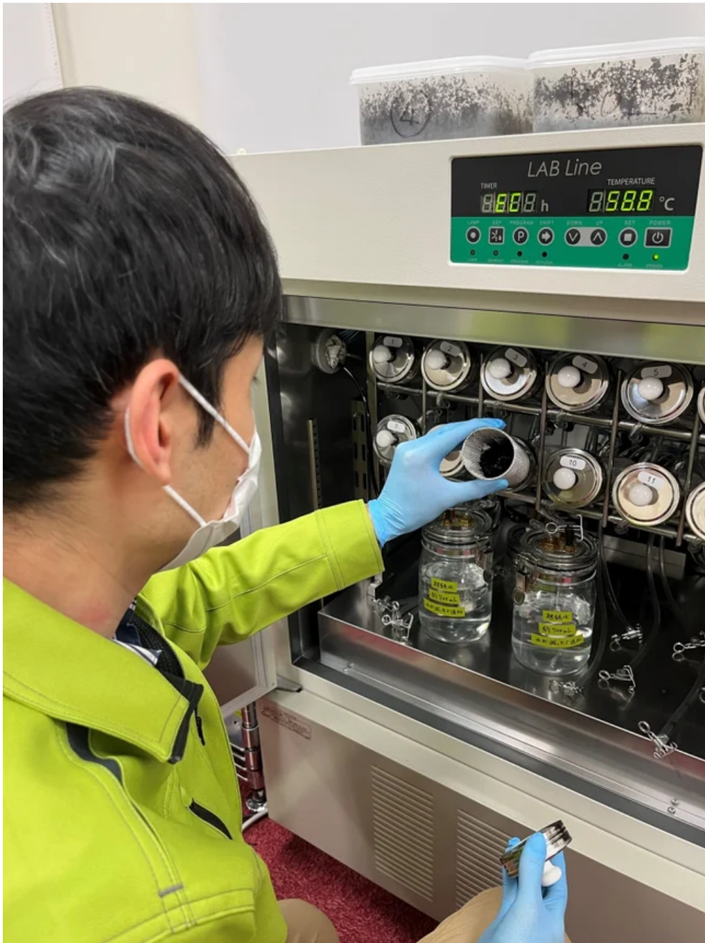
JIS K 6953-2 (ISO 14855-2) に基づくコンポストを用いた生分解性試験設備
