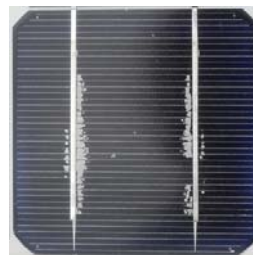
バスバー周辺の剥離
