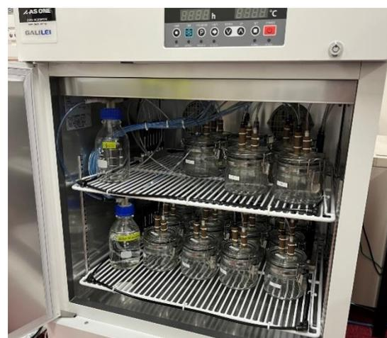
海水を用いた生分解性試験設備
