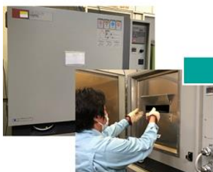
オーブンを使用した従来の試験方法
