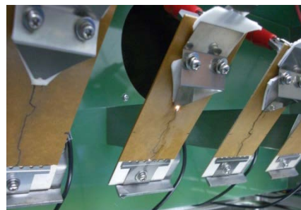
傾斜面トラッキング性試験
