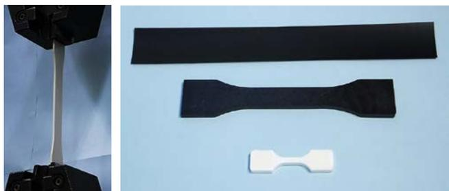
一軸方向の引張荷重を一定速度で加え、材料の破断強度や伸びおよび弾性率を求めます。1mm 以上の高分子材料で用いられる ASTM D638 のダンベル形状や、フィルムサンプルで用いられる ASTM D882 の短冊形状を用いた試験が可能です。また ISO 527 や JIS K7161 などにも対応しております。
