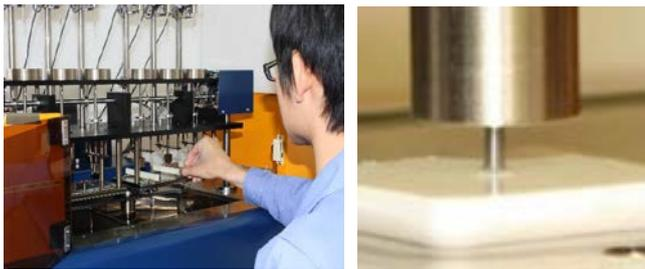
材料の耐熱変形性を評価します。針状圧子で材料に荷重をかけながらオイルに沈め、オイルを所定の速度で昇温しながら材料への侵入深さが  $1\text{mm}$  となる温度を求めます。サンプルサイズが  $\phi 10\text{mm}$  や  $10 \times 10\text{mm}$  でも可能なため、最終製品での試験によく用いられます。ASTM D1525, ISO 306 および JIS K7206 に基づく試験を行うことができます。VST の他に VT や VSP などとも略称されます。
