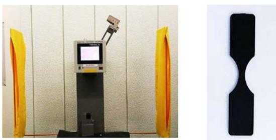
材料の衝撃に対する強さを求めることで材料の靱性の指標となります。サンプルのくびれ部分に引張荷重を瞬時に加えることで衝撃を与えます。両端を締め付け支持するため、アイゾット衝撃やシャルピー衝撃試験では実施困難なフィルム等の薄いサンプルでも試験が可能です。ASTM D1822、ISO 8256 および JIS K7160 に基づいた試験が可能です。
