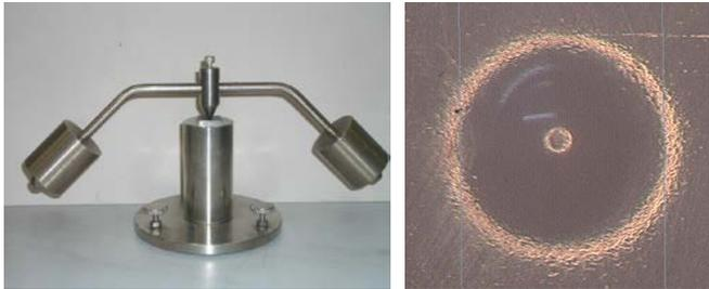
材料の耐熱変形性を評価します。任意温度に設定したオープン（気中）にて、 $\phi 5\text{mm}$  のボール状圧子で材料に  $20\text{N}$  の荷重を 1 時間かけ、へこみ径が  $2\text{mm}$  以下なら合格となります。IEC60695-10-2 および電気安全法（電安法）の A 法（気中）に基づいた試験を行うことができます。さらに右記荷重たわみ温度試験機にて電気安全法 B 法（油中）も試験可能です。
