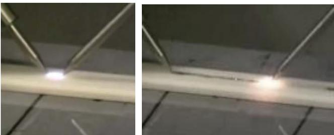
高電圧アークに対する耐トラッキング性を評価します。トラッキングが発生してから、電極を引き離しながらトラッキングが伸びる速度を求め、トラッキングの伝達しやすさを評価します。UL746A に試験方法が記載されており、UL 評価で要求されることがあります。
