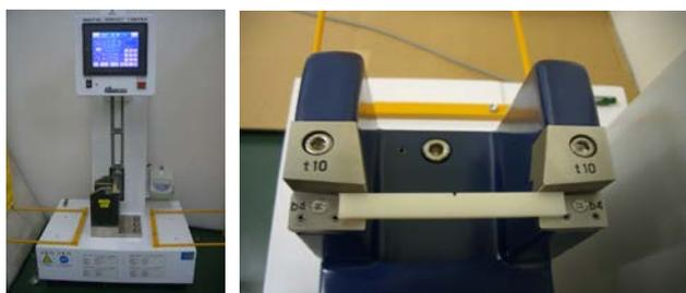
引張衝撃試験やアイゾット衝撃試験と同じように、材料の衝撃に対する強さを求めることで材料の靱性の指標となります。サンプルにはアイゾット衝撃試験と同様にノッチと呼ばれる切欠きを機械加工で施します。サンプルを横置きにすることがアイゾット衝撃試験と異なります。サンプルを置くだけで試験が可能であり、締め付けトルクによる影響のない試験です。ASTM D6110、ISO 179 および JIS K7111 の試験が可能です。ノッチの加工も可能です。
