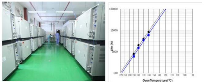
高分子材料は、高温下で使用されると、機械的特性、電気的特性および燃焼性が低下します。オープンを使用して高温下にサンプルを晒し、経時的な変動から材料の熱劣化傾向を把握することは大変重要なことです。ケミトックスでは 300 台近いオープンを保有して、長期熱劣化試験に対応し、RTI（相対温度インデックス）の取得のための試験評価を実施しています。UL 746B および IEC 60216 に基づいた試験が可能で 30 年の評価実績に基づき丁寧なコンサルティングを行っています。
