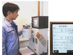
熱可塑性高分子材料の最適な成形条件を得るためには、熔融時流動性を測定することが非常に重要です。A法とB法があり、ASTM D1238、ISO 1133などの試験が可能です。品質管理としてもご利用ください。
