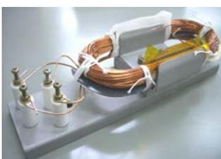
マグネットワイヤと高分子材料との組み合わせによって、UL1446 に基づき温度インデックスを取得することができます。これによりコイルを用いた製品に温度クラスを得ることができます。
