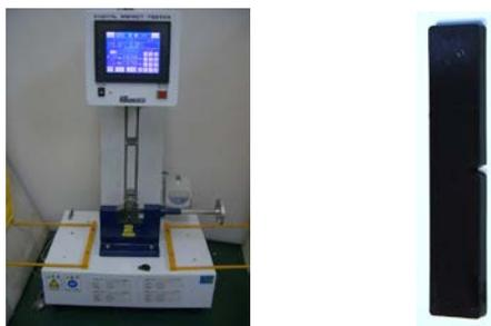
引張衝撃試験と同じように、材料の衝撃に対する強さを求めることで材料の靱性の指標となります。サンプルにはノッチと呼ばれる切欠きを機械加工で施し、この位置に衝撃力を集中させてサンプルの破壊エネルギーを測定します。ASTM D256、ISO 180 および JIS K7110 に基づいた試験が可能です。バーサンプルの成形だけでなくノッチの加工も行っております。
