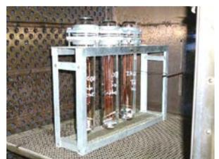
マグネットワイヤと高分子材料は絶縁の機能を目的としますが、シールドチューブ試験では、絶縁以外を目的としたテープ・ワニス・リードワイヤ・スリーブなども温度クラスを持つシステムに加えることができます。
