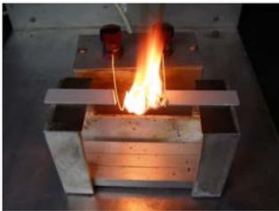
機器の故障により活電部が異常発熱した際、周辺の高分子材料が発火し火災の原因となります。ニクロム線を巻き付け、0.26W/mm の電力密度で加熱して発火するまでの時間を測定します。
