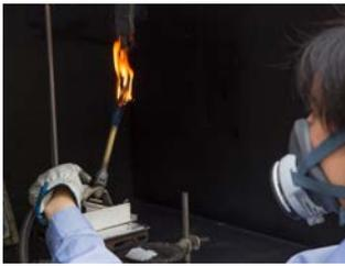
高分子材料は優れた絶縁機能を持ちますが、大切な要素の一つが燃焼性です。活電部に使用される部材には 5V、V-0、V-1 などの燃焼性が、EVA などのモジュール用材料には VTM の燃焼性試験が要求されます。
