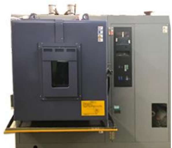
低温減圧複合試験装置写真
