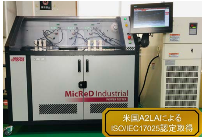
パワーサイクル試験機/過渡熱抵抗測定機(T3Ster)
