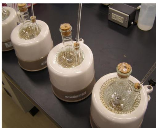
架橋率は、ラミネート後の EVA をキシレンなどの抽出溶媒に浸し非溶解成分の重量を測定することで算出します。これは、架橋反応により分子サイズが大きくなった EVA が、溶媒への溶解性を失うことによるものです。EVA 試料を凍結粉碎により粒径を細かくし、キシレン溶液に浸します。粉末にした EVA を秤量し、メッシュ状の金網容器に入れます。この容器を抽出溶媒に浸し、マントルヒーターにより加熱します。一定条件下で加熱を行った後、容器を取り出し乾燥させ秤量します。
