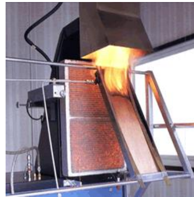
ラジアンパネル試験
