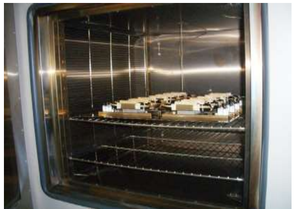
図2 GPM(長期熱劣化試験)例
