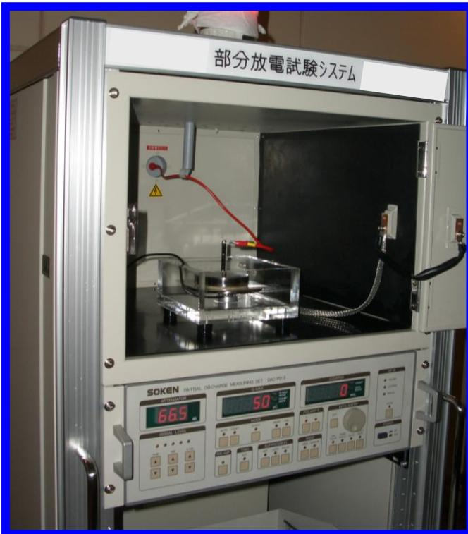
部分放電が消滅した電圧の平均値から、標準偏差を差し引いた値が、最高システム電圧の 1.5 倍以上となることが要求されています。
