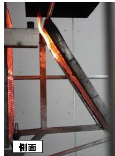
火炎伝播試験(ラジアントパネルテスト)だけではなく、比較トラッキング、傾斜面トラッキング、キセノンアークUV試験、部分放電試験、燃焼試験、大電流アーク発火試験、グローワイヤー試験、ホットワイヤイグニッション試験、UL746B 長期熱劣化試験など太陽電池に使用される材料の試験についても、アメリカの試験・校正ラボの認証機関であるA2LA(The American Association for Laboratory Accreditation)による監査を受け、ISO/IEC17025(試験機関に要求される品質保証システムの規格)の認証も取得しておりますので、信頼性の高いデータを提供することができます。
