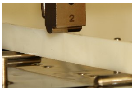
図2 荷重たわみ温度試験
