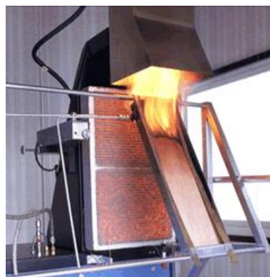
ラジアントパネル試験
