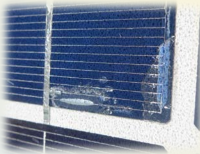
ホットスポットによる封止材の溶解
