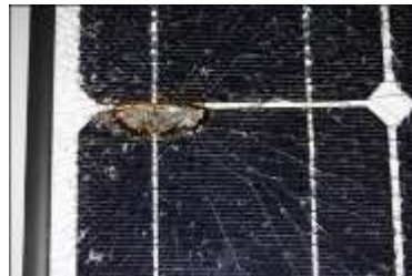
インターコネクトの接続不良による燃焼痕
