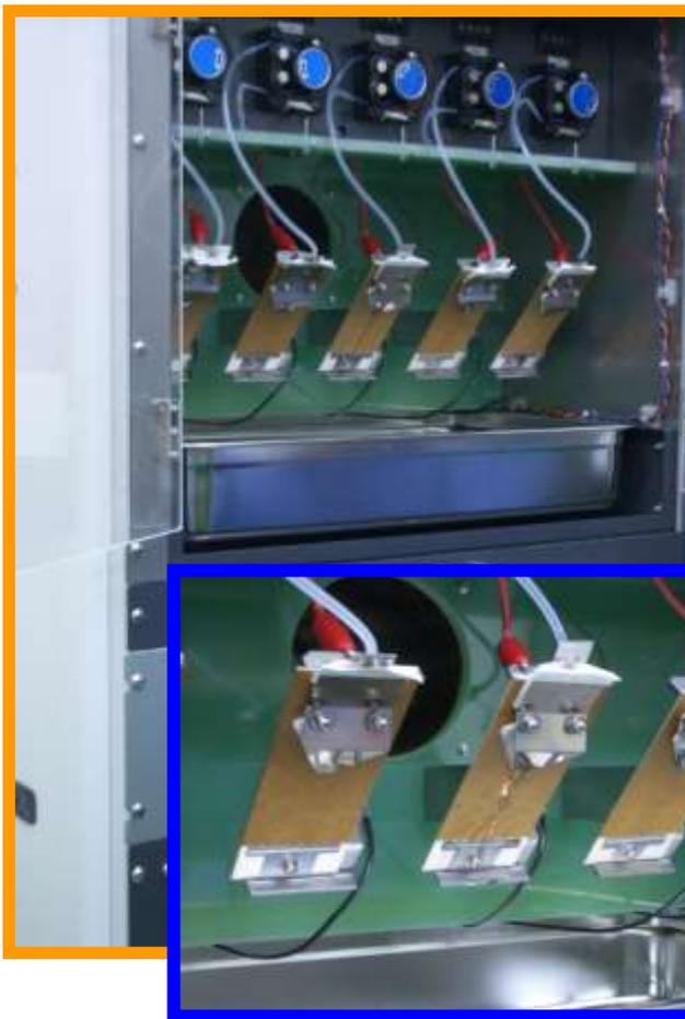
写真のように 45 度傾斜させたサンプルの上下両端に電極を取り付け、電極の間に規定の電圧を印加し、電解液を上部電極から下部電極に向かって流します。トラッキングは下から発生し、下部電極から 25mm 上までトラッキングが発生する時間を測定します。
