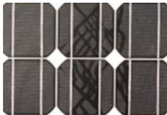
スネイルトレイルが発生した太陽電池モジュール
