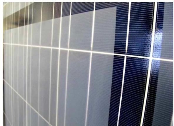
砂塵吹き付けによる摩耗
