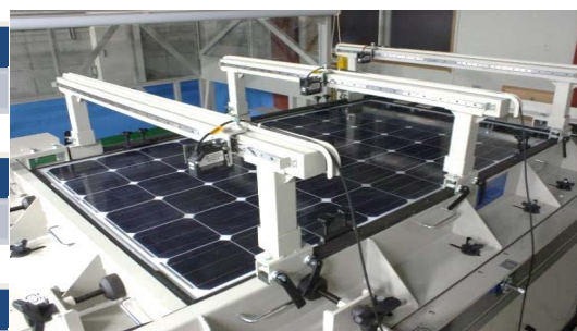
DML時はモジュール各箇所の 変位も測定
