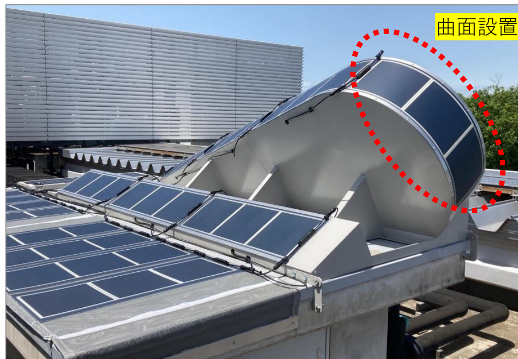
屋根上設置における屋外実証実験 （アイシン・大林組）
