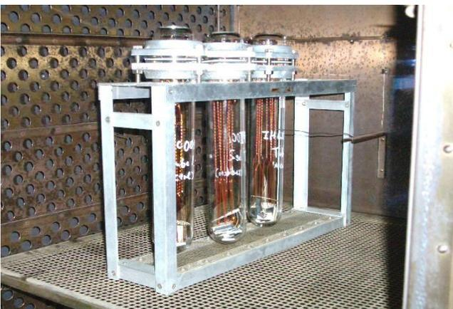
図1 シールドチューブ試験例
