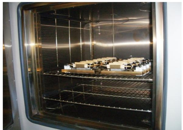
図2 GPM(長期熱劣化試験)例
