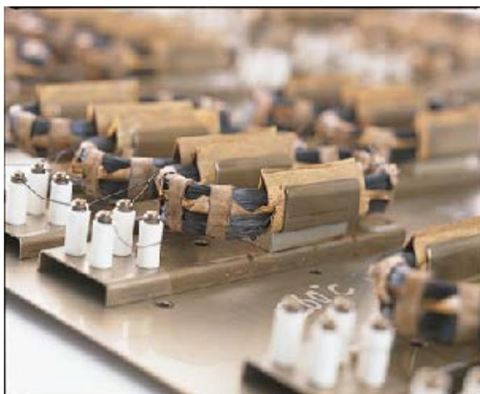
ボビン材、マグネットワイヤ、ワニスなど絶縁性能に影響を及ぼす材料を変更または追加する場合は、GPM(ゼネラルパーパスモデル)と呼ばれるサンプルを準備する必要があります。これはモータレット試験とも言われ、1年以上にわたる長期熱劣化試験が必要となります。左の写真のように、実際の製品に使用されるマグネットワイヤ、絶縁材料を用いて評価します。評価に用いた絶縁材料の厚さが製品で使用できる最小厚さとなりますので評価開始時には製品設計を考慮した厚さを選定する必要があります。
