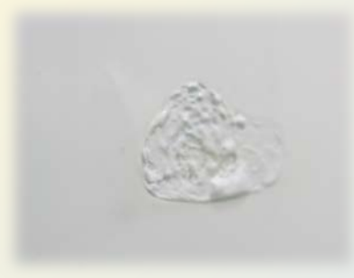
ホットスポットによるバックシートの溶解
