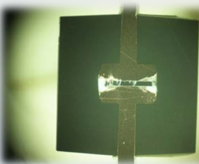
ダイオードの熱衝撃後のクラック分析
