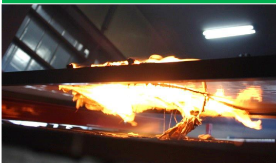
屋根材、モジュール間の燃焼ブランド試験
